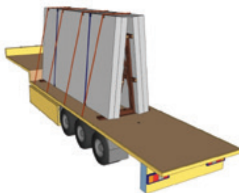
Figur 48: Fastgørelse med en kombination af blokering, A-ramme, rundsurring og surring over toppen
