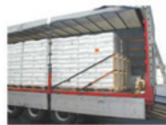
Figur 39: Fjederbelastet surring med paller
