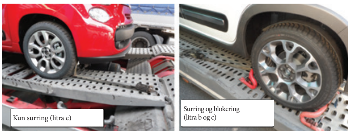
Figur 57: Fastgørelsesanordninger til biltransport
