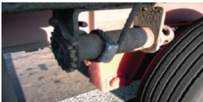
Figur 24: Stålwire spændt med spil
