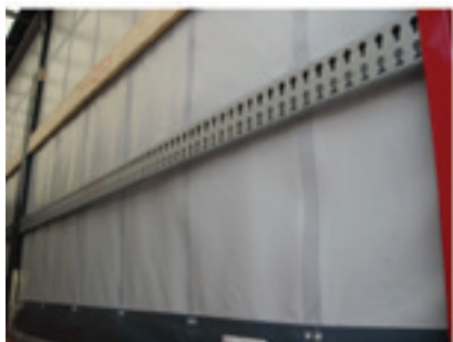
Figur 27: Aluminiumslægte med huller til blokeringsstænger
