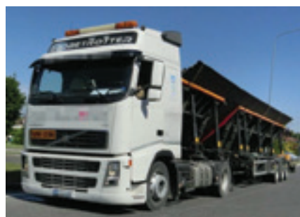
Figur 14: Stålplader transporteret under 45°
