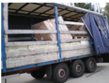
Figur 19: Utilstrækkelig fastgørelse af last udelukkende med strækfilm
