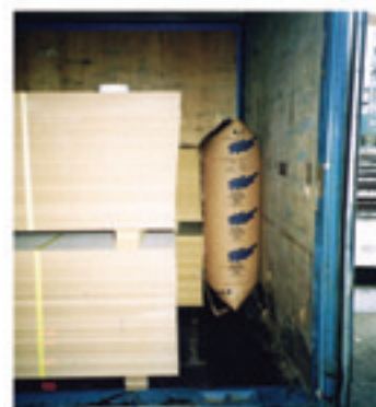
Figur 29: Luftpuder til blokering i siden
