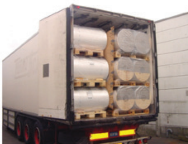
Figur 28 Fyldmateriale mellem rækker af last
