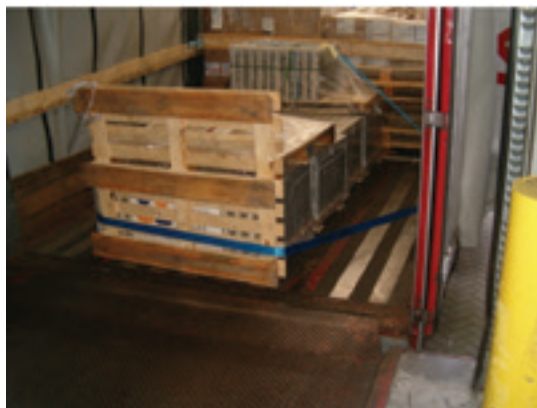
Figur 75: Anordning til fastgørelse bagud til blandet last
